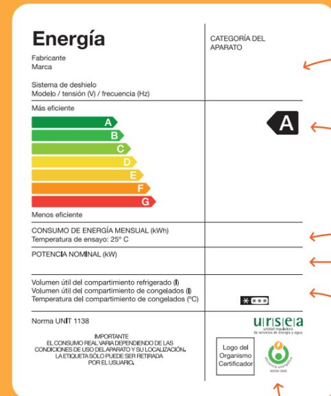
Aquí se encuentra la identificación del fabricante, la marca, el modelo y características técnicas del equipo.
